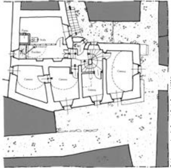
Casa Sertore (Lanzada) – Grundriss Erdgeschoss und 1. Obergeschoss – links oben die Backstube mit Heizofen.
